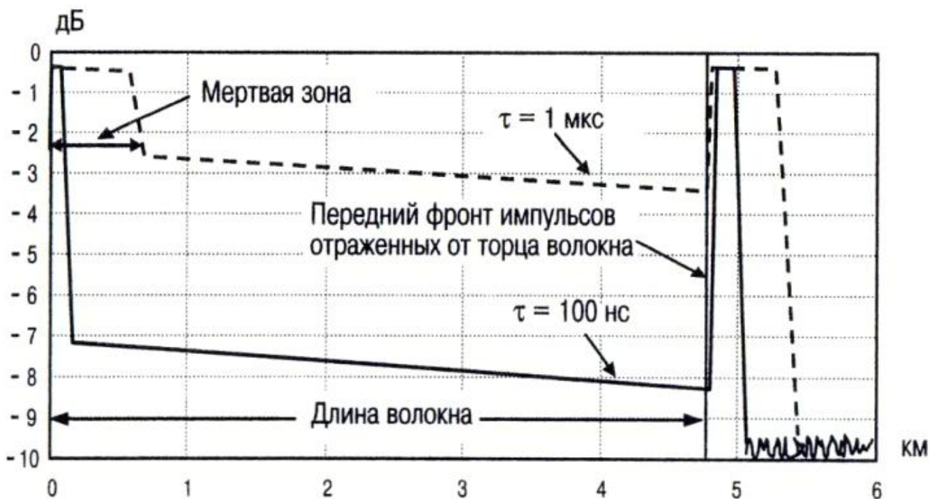
Рис. 3.1. Измерение длины волокна по сигналу отражения от конца волокна
