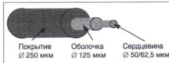
Рис. 1.1. Геометрические параметры одномодовых и многомодовых волокон
