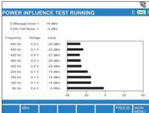
Измерение влияния наводок от электрической сети до 9-ой гармоники
